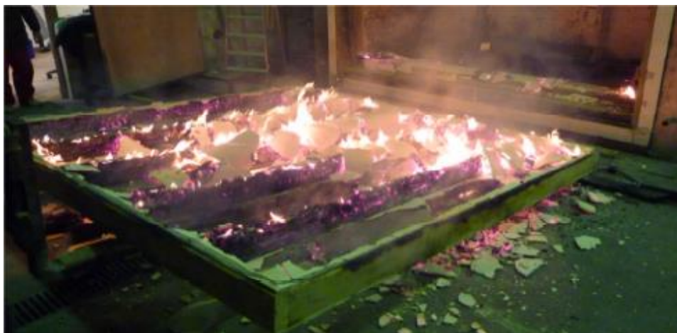
Obr. 3 Stěna lehkého skeletu po požáru
