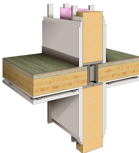
Obr. 6 Detail styku stěnové a stropní konstrukce
