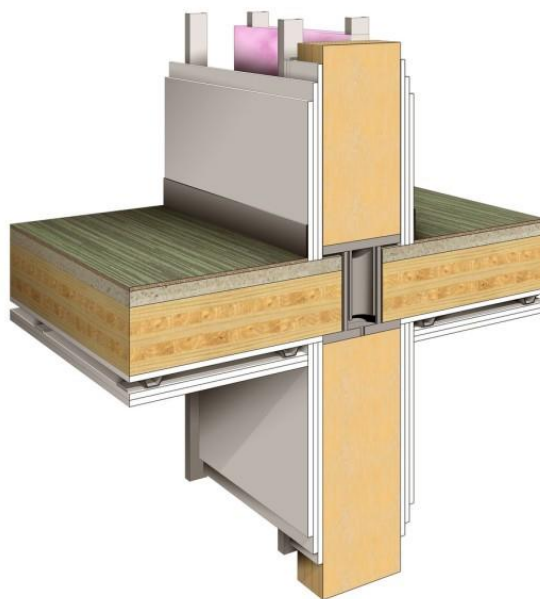
Obr. 22 Detail styku stěnové a stropní konstrukce
