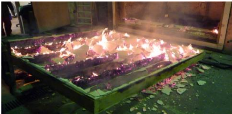
Obr. 5 Stěna lehkého skeletu po požáru
